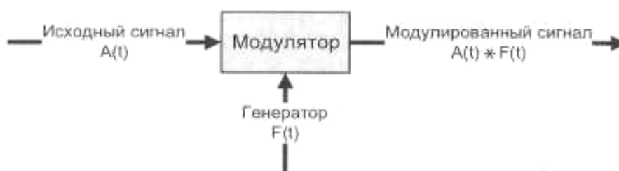
Рисунок 1 - Принцип работы аналогового модема
